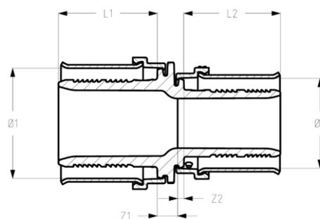
∅: diamètre extérieur tube FLUXO
