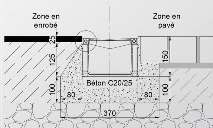
2. En cas d'utilisation sur un support autre que les caniveaux Connecto, veillez à laisser un espace entre tampon pour permettre une libre dilatation.
