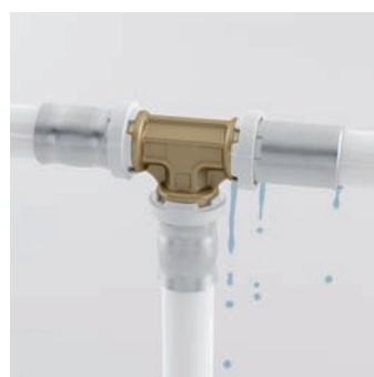
Fuite visualisable lors du test pression en cas d'oubli de sertissage.
