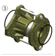
Remplacer et graisser les joint n°2 (VJEC--\*) d'étanchéité avec les embases a coller (graisse silicone pour contact alimentaire)
