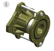
Insérer le piston dans l'axe de manière a ne pas pincer les joints. Ré-assembler le compensateur et remonter les vis n°9 (VISEP12/195) avec un couple de serrage de 40Nm
